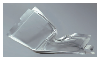
衝突試験で発煙・発火しなかったスタックセル
